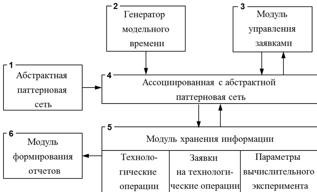
Рисунок 5.10 – Функциональная схема имитационной модели технологической системы (составлено автором)
