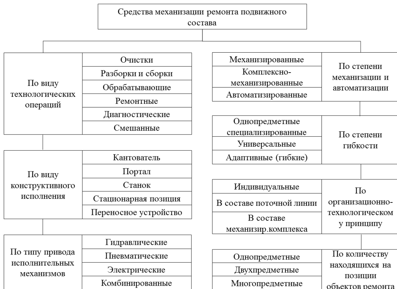
Рисунок 1.6 – Классификация механизированного технологического оборудования для ремонта подвижного состава (составлено автором)
